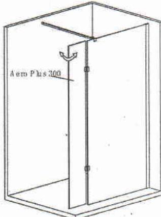
3. Pomocí příčky zabezpečte zástěnu k protější zdi či ke stropu.
