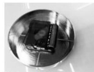
16. Nainstalujte baterii do hodinového mechanismu.
